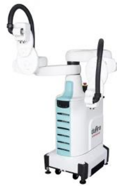
2本の腕を持つアームロボット duAro2 (画像提供：川崎重工業株式会社)
